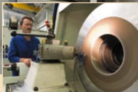
Bearbeitung eines Drehteiles auf einer NC Zykeldrehmaschine.
