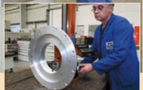
Vermessung eines präzisen Dichtringes für ein Hochleistungsgetriebe.
